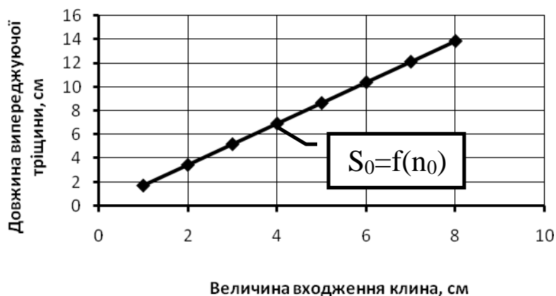
Рис.4. Вплив величини входження клина в деревину n_0 на довжину випереджуючої тріщини S_0
